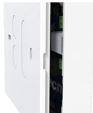
Diseñado con ranuras para una buena ventilación de los componentes electrónicos.
