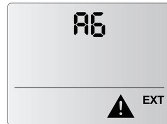
Detiene y bloquea la unidad. Para desbloquearla, hay que desconectar la alimentación. Se activa con la entrada digital DIN3 del control.
