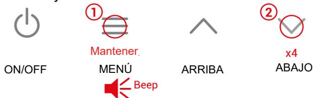
En este menú se pueden modificar parámetros de la cortina de aire como el retardo de puerta, la velocidad y calefacción máximas cuando la puerta está abierta y/o cerrada, la frecuencia de mantenimiento del filtro, unidades de temperatura, guardado de memoria o ajustar el modo boost.
