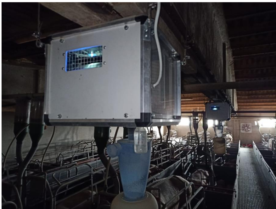
Figura 1. Prototipo del equipo con sistema Ciclónico. Caudal de aire: 100 m 3 /h.
