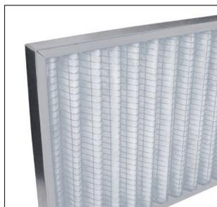
Filtros planos G4 fabricados con media sintética plegada en zig-zag, marco de acero galvanizado con rejilla metálica en ambos lados.
