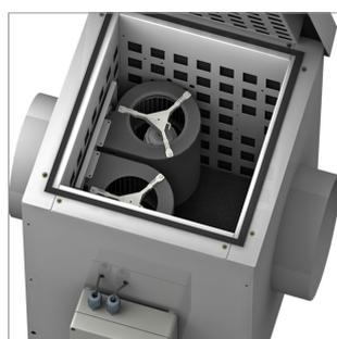
Internamente recubierto con laminado perforado de acero galvanizado. Ventiladores centrífugos de doble aspiración con palas hacia delante, fáciles
