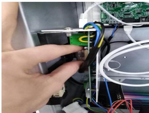
En el caso del K7 600 A OH+FC SS, la placa se encuentra dentro de la caja estanca situada encima del purificador. Simplemente desatornillar la tapa y sacar el fusible con la mano o la ayuda de un destornillador y reemplácelo.
