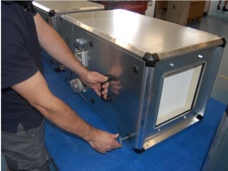
Una vez abiertos los puntos de sujeción, retirar el panel con el asa.
