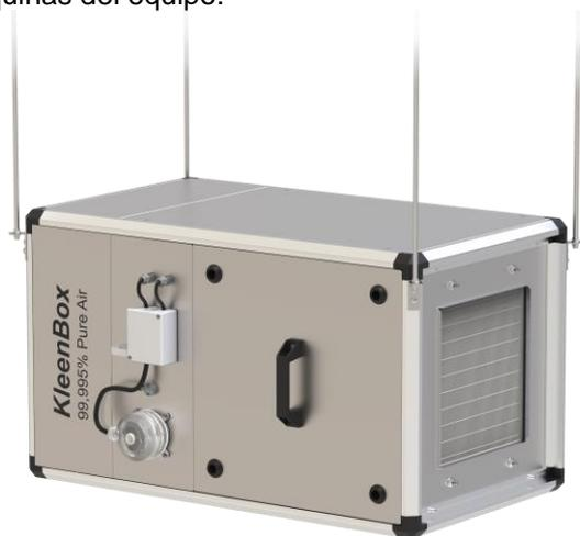
El anclaje debe dimensionarse de acuerdo con los pesos de cada equipo indicados en la página de datos técnicos (ver página 6). La instalación puede realizarse mediante vástagos roscados, tensores u otros soportes no incluidos con el equipo.
