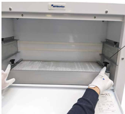
5- Aflojar los pomos roscados y las grapas del filtro absoluto.
